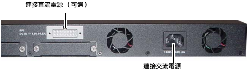
圖 1-15. 交換器的交流和直流電源連接
